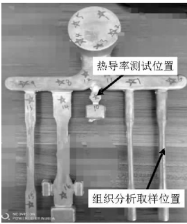
图 1 压铸力学性能试棒及热导率试样
